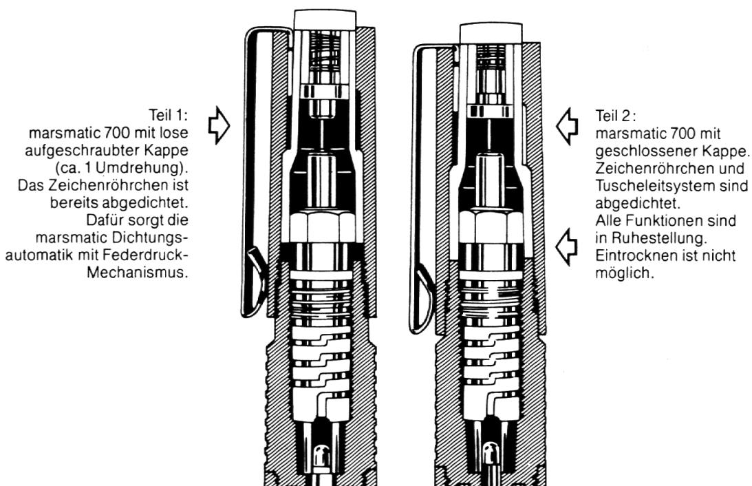
Hier sehen Sie, was Sie nicht sehen: die marsmatic Dichtungsautomatik mit Federdruck-Mechanismus, die sicher dafür sorgt, daß die Tusche im Zeichenröhrenchen nicht eintrocknet. Selbst nach mehreren Monaten Ruhezeit schreibt der marsmatic 700 sofort an. Anschütteln ist überflüssig. Mit diesem Vorteil allein funktioniert ein Tuschezeichner aber noch nicht so präzise wie ein Computer. Deshalb haben wir in den
