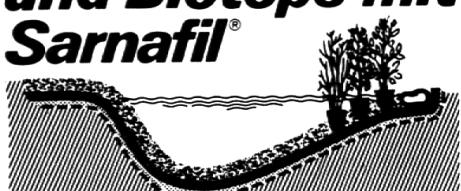
Die grüne Sarnafil-Kunststoff-Dichtungsbahn wurde speziell für die Abdichtung von Teichen und Biotopen geschaffen. Sie genügt den hohen Anforderungen (mechanische Beanspruchung, Wurzelbeständigkeit usw.) und passt sich der natürlichen Umgebung farblich an. Sarnafil-Abdichtungsbahnen werden nach Mass im Werk (bis ca. 80 m<sup>2</sup>) angefertigt, bei größeren Anlagen auf der Baustelle.
