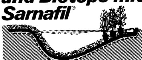
Die grüne Sarnafil-Kunststoff-Dichtungsbahn wurde speziell für die Abdichtung von Teichen und Biotopen geschaffen. Sie genügt den hohen Anforderungen (mechanische Beanspruchung, Wurzelbeständigkeit usw.) und passt sich der natürlichen Umgebung farblich an. Sarnafil-Abdichtungsbahnen werden nach Mass im Werk (bis ca. 80m²) angefertigt, bei größeren Anlagen auf der Baustelle.
