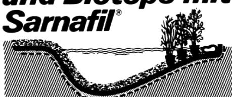
Die grüne Sarnafil-Kunststoff-Dichtungsbahn wurde speziell für die Abdichtung von Teichen und Biotopen geschaffen. Sie genügt den hohen Anforderungen (mechanische Beanspruchung, Wurzelbeständigkeit usw.) und passt sich der natürlichen Umgebung farblich an. Sarnafil-Abdichtungsbahnen werden nach Mass im Werk (bis ca. 80 m<sup>2</sup>) angefertigt, bei größeren Anlagen auf der Baustelle.
