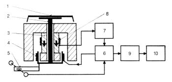
Abb. 2: Prinzip der elektronisch geregelten Kraftkompensation. 1 Waagschale, 2 Schalenträger, 3 Magnet, 4 Spule, 5 Optische Abtastung, 6 Regler/AD-Wandler, 7 Konstantstromquelle, 8 Temperaturfühler, 9 Tara-Rechner, 10 Digitalanzeige
