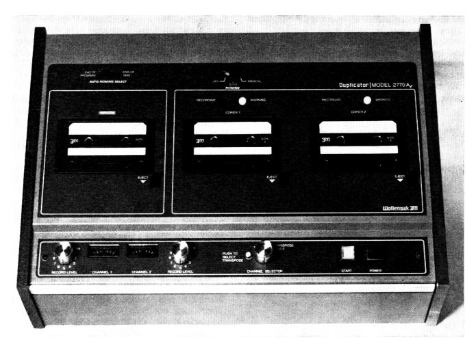
Der 3M-Wollensak-Kassettenkopierer ist äusserst robust und unübertroffen praxisgerecht in der Handhabung. Er erfüllt alle nötigen Funktionen, um mit hoher Geschwindigkeit zwei Kassettenkopien von höchster Qualität in einem Arbeitsgang herzustellen.
