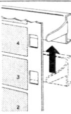
Der Greifer geht wieder in die Ausgangsposition zurück. Dieser fünfstufige Vorgang wiederholt sich je nach Vorführgeschwindigkeit 18 oder 24 mal in der Sekunde. Und genau so oft wird das harte Rattern vermieden, obwohl der Film mit dem optimalen Schaltverhältnis von 1:6,9 transportiert wird.
