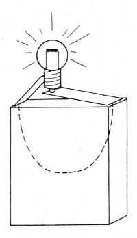
Damit die Lampe brennt, muss der Stromkreis geschlossen sein. Batterie und Lampen brauchen immer zwei Kontaktstellen.
