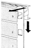
Der Filmgreifer wird präzise in die Perforation eingeführt. Da er sich in dieser Phase vertikal kaum bewegt, trifft er weich auf den Perforationsrand. (Hier wird bereits die erste Geräuschquelle ausgeschaltet.)
