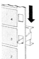
Der Greifer bremst den Film gleichmäßig ab bis zum Stillstand. Dadurch, dass nicht brusk gestoppt wird, kann wiederum ein hartes Aufschlaggeräusch vermieden werden. (Dies bewirkt auch einen maximalen Bildstand.)
