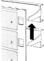
Der Greifer geht wieder in die Ausgangsposition zurück. Dieser fünfstufige Vorgang wiederholt sich je nach Vorführgeschwindigkeit 18 oder 24 mal in der Sekunde. Und genau so oft wird das harte Rattern vermieden, obwohl der Film mit dem optimalen Schaltverhältnis von 1:6,9 transportiert wird.
