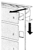
Der Filmgreifer wird präzise in die Perforation eingeführt. Da er sich in dieser Phase vertikal kaum bewegt, trifft er weich auf den Perforationsrand. (Hier wird bereits die erste Geräusquelle ausgeschaltet.)
