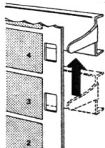
Der Greifer geht wieder in die Ausgangsposition zurück. Dieser fünfstufige Vorgang wiederholt sich je nach Vorführgeschwindigkeit 18 oder 24 mal in der Sekunde. Und genau so oft wird das harte Rattern vermieden, obwohl der Film mit dem optimalen Schaltverhältnis von 1:6,9 transportiert wird.
