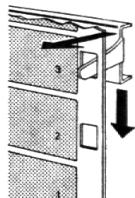
Der Filmgreifer wird präzise in die Perforation eingeführt. Da er sich in dieser Phase vertikal kaum bewegt, trifft er weich auf den Perforationsrand. (Hier wird bereits die erste Geräusquelle ausgeschaltet.)
