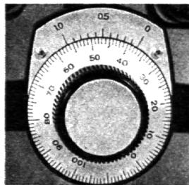
Die Torsionsskala mit Nonius wurde für optimalen Bedienkomfort entwickelt. Mit Hilfe einer individuellen Graviertechnik wird höchstmögliche Genauigkeit mit minimalen Toleranzen erreicht. Über die Noniusablesung sind Gewichtsbestimmungen mit einer Genauigkeit von 0,01 g möglich. Spezialeinrichtung für hydrostatische Wägungen.
