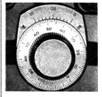
Die Torsionsskala mit Nonius wurde für optimalen Bedienungskomfort entwickelt. Mit Hilfe einer individuellen Graviertechnik wird höchstmögliche Genauigkeit mit minimalen Toleranzen erreicht. Über die Noniusablesung sind Gewichtsbestimmungen mit einer Genauigkeit von 0,01 g möglich. Spezialeinrichtung für hydrostatische Wägungen.
