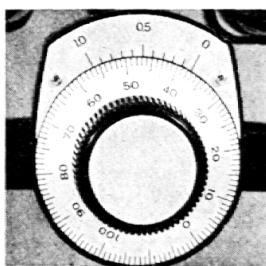
**Die Torsionsskala mit Nonius** wurde für optimalen Bedienungskomfort entwickelt. Mit Hilfe einer individuellen Graviertechnik wird höchstmögliche Genauigkeit mit minimalen Toleranzen erreicht. Über die Noniusablesung sind Gewichtsbestimmungen mit einer Genauigkeit von 0,01 g möglich. Spezialeinrichtung für hydrostatische Wägungen.
