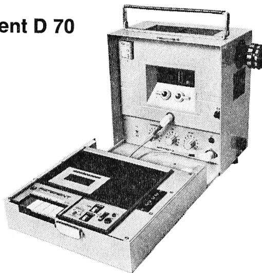
mit: Mikro- und Radio/Phono-Eingang, Impulsetzteil, 2. LS-Ausgang, Halogenlampe 24 V/250 W.
