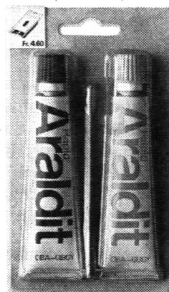
Araldit Rapid eignet sich speziell für kleinere Arbeiten. Denn die Mischung kann nur während 6–9 Minuten verarbeitet werden. Dann setzt die Härtung ein. 10 Minuten nach dem Zusammenfügen ist die Verbindung selbsttragend. Und nach 2–4 Stunden belastbar.
