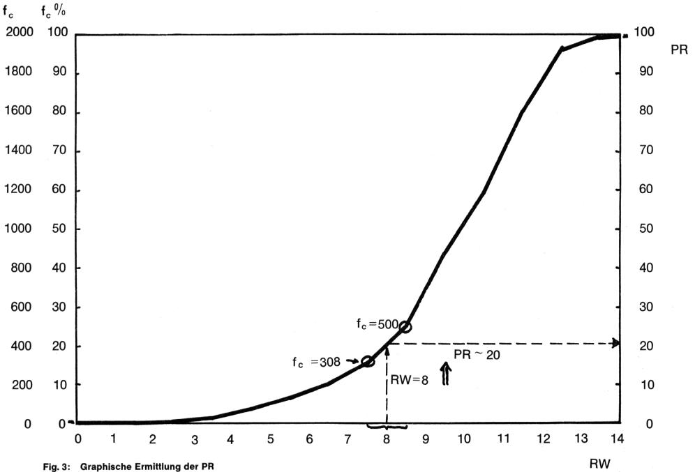
Fig. 3: Graphische Ermittlung der PR
