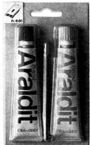
Araldit Rapid eignet sich speziell für kleinere Arbeiten. Denn die Mischung kann nur während 6–9 Minutenverarbeitetwerden. Dann setzt die Härtung ein. 10 Minuten nach dem Zusammenfügen ist die Verbindung selbsttragend. Und nach 2–4 Stunden belastbar.
