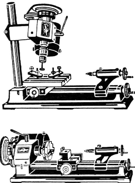
Unzählige Möglichkeiten der Bearbeitung von Holz, Metall oder Kunststoff eröffnen sich Ihnen: Als Drehbank, Spitzenhöhe 36 mm, Spitzenweite 175 mm. Sie können drehen, bohren, fräsen, kreisschneiden, hobeln, laubsägen, Gewindeschneiden, schleifen und vieles mehr!
