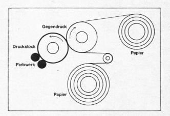
erfolgt durch das Abrollen einer runden stereotypischen Druckplatte und eines Druckzylinders, wobei das von Rollen ablaufende Zeitungspapier zwischen den beiden Zylindern hindurchgeführt wird. Vom Satz wird eine Kartonmatrize (Mater) geprägt, welche als Gießform für den Guß der runden Druckplatte dient.
