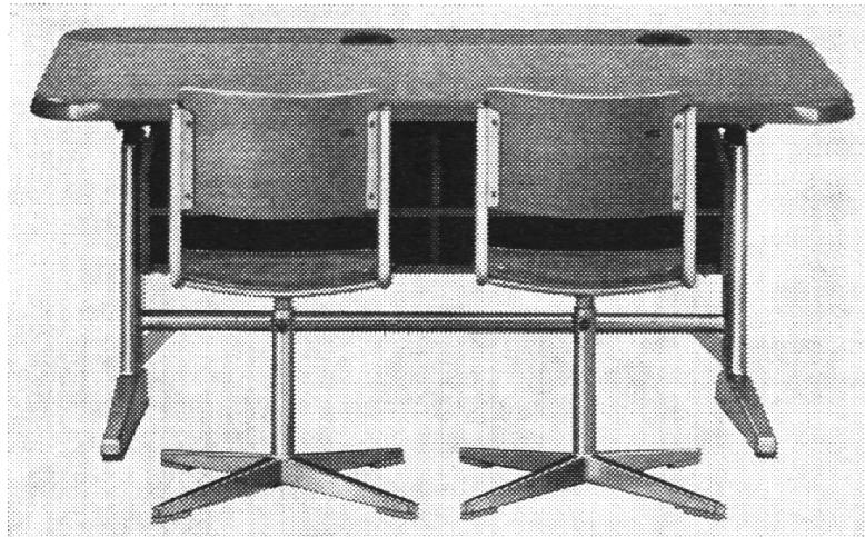
Tischplatte 120 x 56 cm, in Formpressholz, mit Pressholzbelag (Messerfurnier) oder mit Kunstharzbelag, Höhenverstellung mit Embru-Getriebe oder Federmechanismus und Klemmbolzen, mit oder ohne schrägstellbarer Tischplatte, Tischhöhe speziell verstellbar.
