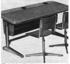
Tischplatte 120 x 53 cm, in Pressholz, Messer- und Schälfurnier oder Kunstharzbelag, Höhenverstellung mit Embru-Getriebe oder Federmechanismus und Klemmbolzen, mit oder ohne schrägstellbarer Tischplatte, Tischhöhe speziell tiefstellbar.
