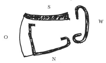
Die Grundlage: Die Kapelle wird in den kosmischen Raum eingebaut: eine Seite nach Sonnenaufgang, eine nach Sonnenuntergang, eine nach Osten, eine nach Westen. Lichtfänger für jede Tageszeit werden geplant: die Türme. Der Ost-Turm erwartet die ersten Strahlen der aufgehenden Sonne und leitet sie ins Innere der Kirche. Sein Zwillingsbruder blickt nach W, nach Sonnenuntergang.
