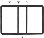
Lage der Kartonteile auf dem Überzugstoff der Einbanddecke. In der Mitte die Rückeneinlage.
