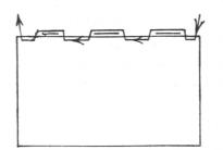
Schematischer Querschnitt der Handheftung mit Faden auf Band
