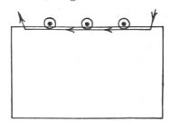
Schematischer Querschnitt der Handheftung mit Faden auf Hanfschnur.
