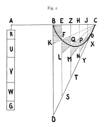
Trapezen KE, LZ usw., aufgehängt in A. Werden die ersten Trapeze aber nicht an diesen Punkten, sondern an den Strecken BE, EZ usw. aufgehängt, so sind sie im Gleichgewicht mit R, U, V usw. Mithin sind die Flächenstücke R, U, V usw. kleiner als die Trapeze KE, LZ usw. Somit ist die Summe R + U + V + W + G, also ein Drittel des Dreiecks BCD, kleiner als die Summe der Trapeze KE, LZ usw. und des Dreiecks IXG, die zusammen das Parabelsegment überdecken.
