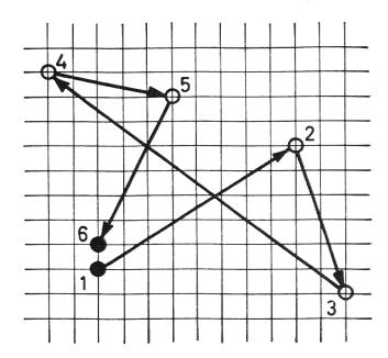
Von 1 bis 2 Richtung 10,5 Distanz 47 m von 2 bis 3 Richtung 29 Distanz 31 m von 3 bis 4 Richtung 55 Distanz 75 m von 4 bis 5 Richtung 18 Distanz 25 m von 5 bis 6 Richtung 37 Distanz 33 m (alle Maße gemessen)
