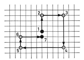
Von 1 bis 2 Richtung oo Distanz 15 m von 2 bis 3 Richtung 16 Distanz 20 m von 3 bis 4 Richtung 32 Distanz 30 m von 4 bis 5 Richtung 48 Distanz 40 m von 5 bis 6 Richtung oo Distanz 10 m
