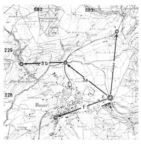
Lösung: Wir tragen auf ein karriertes Blatt (4 cm = 1 km, Maßstab 1:25000) die Koordinaten ein. In dieses Netz setzen wir die Punkte (Standort) und (Ziel(e)). Die Marschrichtung messen wir mit dem Kompaß und die Distanzen mit dem Maßstab aus der Skizze. Die anzulaufenden Punkte sollen besonders ausgezeichnet sein, damit eine Kontrolle möglich wird. Wir geben diese Angaben nach Punkten getrennt in verschlossenen Couverts mit, diese dürfen erst geöffnet werden am Ziel, respektiv Teilziel.
