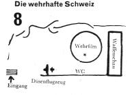
Die drei 48 m hohen Stahlspitzen, die in den Himmel stechen, stellen unsere Wehrhaftigkeit gegen oben dar, und der Pavillon selbst, aus 141 vorfabrizierten Betonstacheln von je 3,5 Tonnen Gewicht versinnbilden den (Igel Schweiz). Verbaut wurden total 3000 Kubikmeter Beton. Im Kinoraum (Ober-
