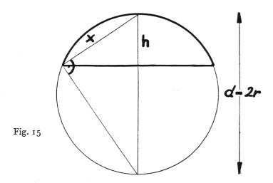
3. Der Zylinder, der gleiche Grundfläche besitzt mit dem größten Kreise einer Kugel, dessen Höhe aber gleich dem Durchmesser der Kugel ist, ist sowohl seinem Inhalte als auch seiner Oberfläche nach anderthalbmal so groß wie die Kugel:
