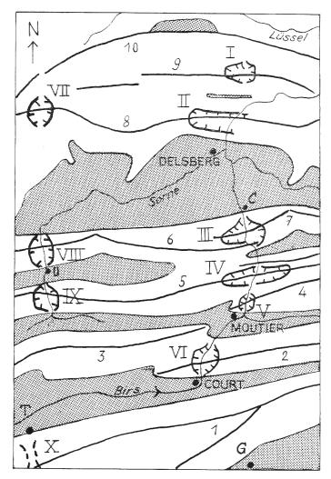
Abb. 2 Geologische Kartenskizze der Birsklusen bei Moutier. Weiße Zonen = gefaltete Jurakalke. Graue Zonen = Tertiärmulden. Numerierte schwarze Linien = Faltenachsen.
