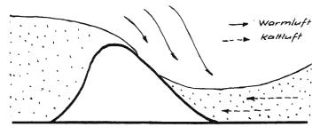
Antizyklonales Absinken der Luftmassen bei beginnender Föhnlage (nach K. Frey).
