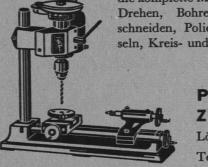
die komplette Maschinenwerkstätte zum Drehen, Bohren, Fräsen, Gewindeschneiden, Polieren, Schleifen, Drechseln, Kreis- und Laubsägen.
