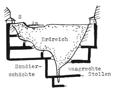
Wägital-Kraftwerk. Vorarbeit für die Staumauer: Feststellung des unterirdischen Felsverlaufes. Der tiefste Schacht lag 40 m unter der Erdoberfläche.
