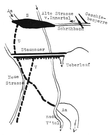
Wägital-Kraftwerk. Vorarbeit für die Staumauer: Trockenlegung der Baustelle durch Schutzdamm (S), Umgehungsstollen (U) und Vorflutstollen (V). Der Umgehungsstollen dient heute als Grundablaß. Der Vorflutstollen besorgte die Grundwasserentfernung.
