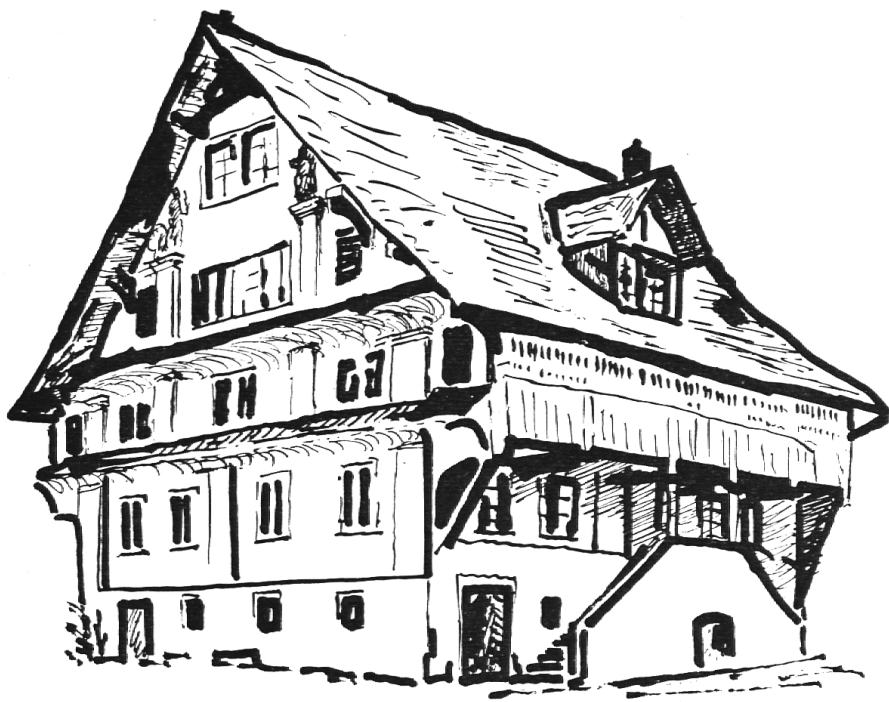
Der «Kronenhof» in Schübelbach, 1765, zeigt verputzten Blockbau mit Stuckpilastern, den Eindruck eines Steinhauses erweckend. An der Giebelwand der Vorderseite als Schmuck künstlerisch zwar nicht wertvolle Fassadenmalereien.
