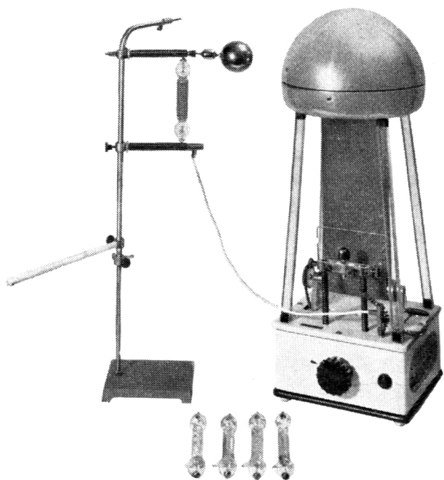
Bandgenerator mit Gegenkugel und Geißleröhren
