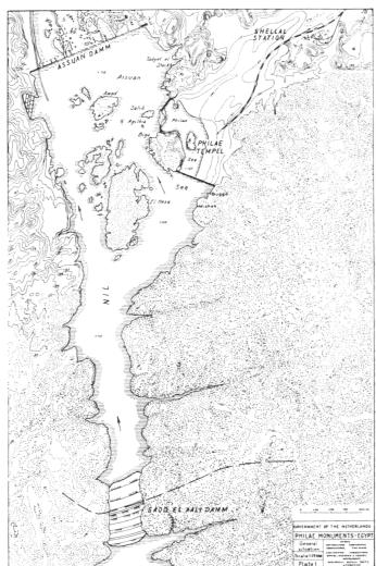
Karte von Philae und Umgebung mit dem alten und neuen Staudamm; bei Philae sind die geplanten Schutzdämme eingezeichnet.
