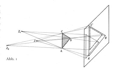
Ergebnis: Alle Seiten sind im gleichen Verhältnis vergrößert worden. Das Verhältnis der Strecken Lichtpunkt – Bildpunkt zu den entsprechenden Strecken Lichtpunkt – Gegenstandspunkt ist stets dasselbe und stimmt mit dem Vergrößerungsverhältnis überein.
