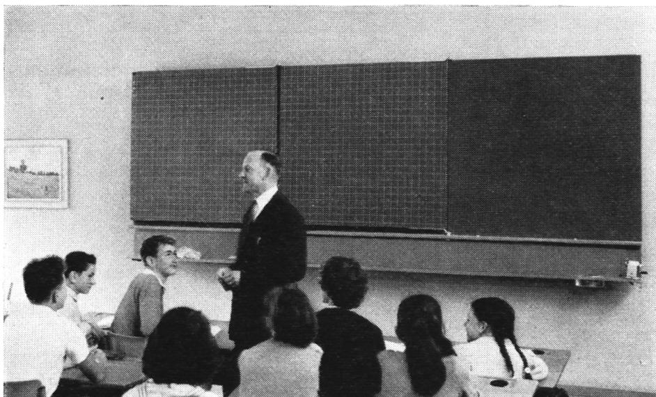
Diese Klasse verfügt über eine Wandtafel von 10 m<sup>2</sup> Schreibfläche. Es ist die 7-teilige **palor** Buchwandtafel HL-B7 (Größe 37). Zwei Flügel lassen sich wahlweise übereinander klappen, wodurch 4 Schreibflächen zugedeckt werden, die entweder für eine andere Klasse oder eine andere Unterrichtsstunde bestimmt sind.
