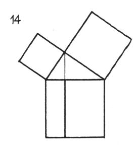
Abb. 15: Das Rechteck aus den Hypotenusenabschnitten ist gleich groß wie das Höhenquadrat (Höhensatz). Das Höhenquadrat bildet aber mit dem Quadrat über dem Hypotenusenabschnitt zusammen das Kathetenquadrat (Pythagorassatz). Folglich bildet auch das Rechteck aus den Hypotenusenabschnit-
