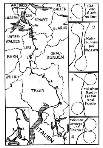
1957 werden 75 Jahre seit der Eröffnung der Gotthardbahn, dieser großartigsten Alpenbahn, verflossen sein – Die geographische Skizze zeigt den Verlauf der Linie Luzern-Chiasso. Zur Überwindung der großen Steigung mußten auf der Nordseite des Gotthard 3, auf der Südseite 4 Kehrtunnels gebaut werden – Die ursprüngliche Zufahrt führte von Luzern nicht über Küßnacht, sondern nach Rotkreuz, diejenige von Zürich über Affoltern-Zug ebenfalls nach Rotkreuz (siehe Skizze links unten!).
