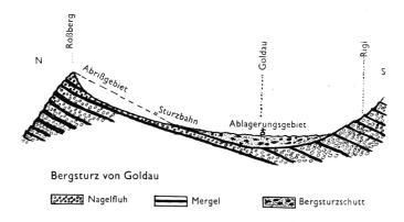
Abb. 1: Profil des Goldauer Bergsturzes
