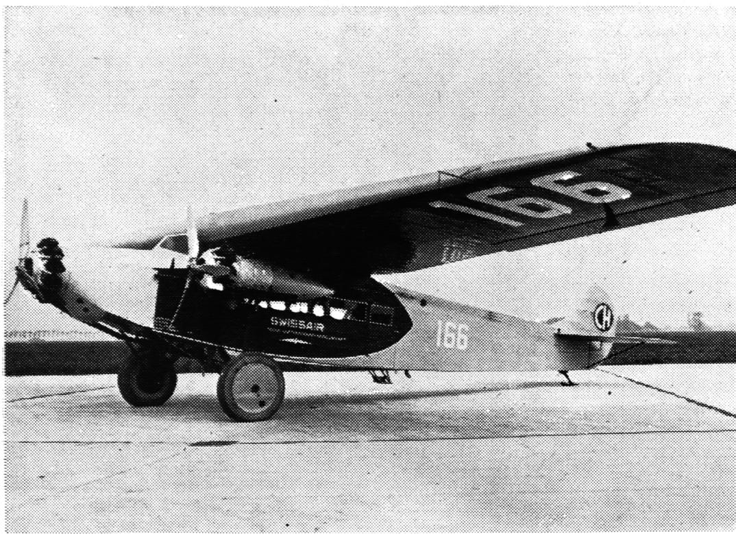
Im Gründungsjahr 1931 war der dreimotorige Fokker F VII-b-3m das Standard-Flugzeug der Swissair. Die Maschine bot Platz für zehn Passagiere und zwei Mann Besatzung. Die drei Motoren entwickelten zusammen 900 PS, die Reisegeschwindigkeit erreichte 175 km pro Stunde, das Zuladegewicht betrug etwas mehr als 1000 kg, und die Reichweite bezifferte sich auf rund 800 km.
