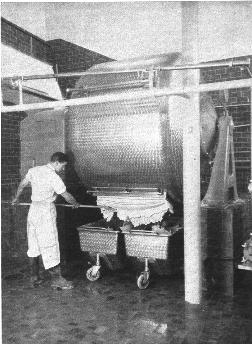
Nach etwa einstündiger Bearbeitung kann die Butter als herrlich duftende Masse im Gewicht von 500 bis 700 kg dem Butterfertiger entnommen werden.
