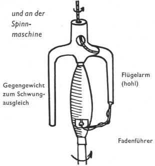
Zur besseren Veranschaulichung des Gesagten und Skizzierten demonstriere ich den Spinnprozeß beim Selfaktor mit Lineal und bunten Fäden, sowie bei der Flügelspinn- und Ringspinnmaschine mittelst einer Flügelspindel (von einem alten Spinnrädchen herstammend) und bunten Fäden, resp. mittelst einem Arbeitselement aus der Ringspinnmaschine. Ich zeige den Schülern auch das Arbeitselement der Flügelspinnmaschine und vergleiche mit dem Flügelspindelchen des alten Spinnrädchens.
