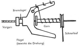
Die Garnspule dreht sich etwas schneller als der Spindelflügel. So wird das Garn gleichzeitig gedreht, verzogen und aufgewickelt.
