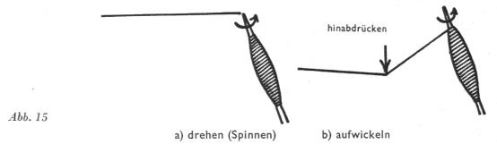
Diese Maschine liefert zwar sehr gleichmäßige, feine Garne, doch wird der Arbeitsgang in regelmäßigen, kurzen Zeitabständen immer wieder unterbrochen. Die Arbeit der Maschine zerfällt in die Tätigkeiten spinnen und aufwickeln. Der Unterbruch im Spinnprozeß bremst selbstverständlich die Produktion und verlangsamt den Arbeitsvorgang.
