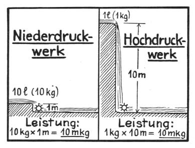
Diese Darstellung zeigt den Unterschied zwischen den beiden Arten von Kraftwerken. Beim Niederdruckwerk haben wir viel Wasser, aber wenig Gefälle, beim Hochdruckwerk wenig Wasser mit viel Gefälle.
