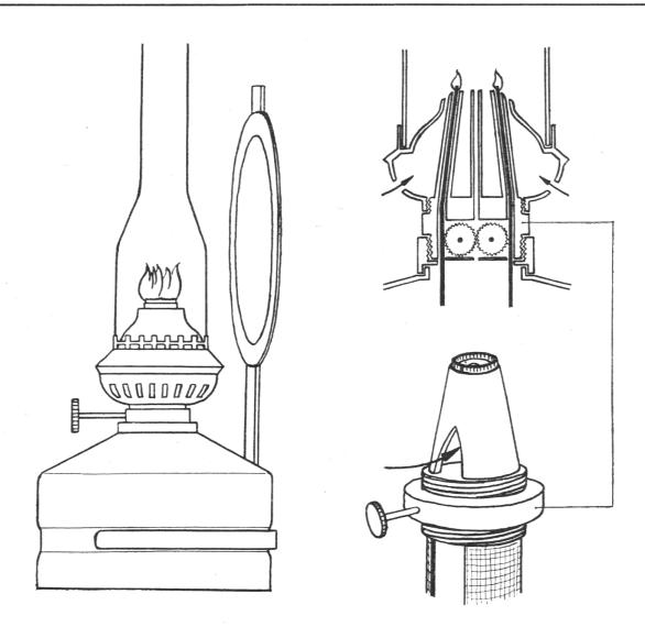
Der Heizstoff ist hier eine leicht entzündliche Flüssigkeit. Der Docht leitet den Brennstoff in geringen, regulierbaren Mengen an eine von der Flüssigkeit entfernte Stelle, unter absoluter Trennung der Verbrennungsstätte von dem Aufbewahrungsraum des Heizstoffes.
