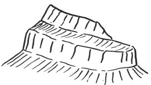
Skizze 5: Bergform im Bereiche der Ablagerungsgesteine. Kalk bildet die Felswände, der weiche Schiefer die Fluhbänder.
