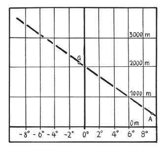
Skizze 6: Mit Hilfe der mittleren Jahrestemperaturen von Altdorf (A) und des St. Gotthard (G) lässt sich ein Diagramm herstellen, das das Ablesen der mitteren Jahrestemperatur für jede gewünschte Höhe ermöglicht.
