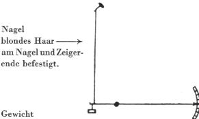
Zeiger aus einem Draht mit einer Windung als Drehpunkt
