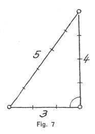
Winkels wird damit auf eine Längenmessung zurückgeführt. Vielleicht davon ausgehend, suchten die ägyptischen Feldmesser überhaupt alle Messungen im Felde auf Längenmessung zurückzuführen. Und darum auch der Name: Seilspanner!
