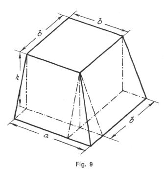
sich die obige Inhaltsformel unmittelbar ableiten lässt. Zu diesem Zwecke denke man sich den Gesamtkörper aufgebaut aus einem Quader mit dem Inhalt h. ab (gebildet aus dem quaderförmigen Innenteil, vermehrt um die beiden kongruenten seitlichen Prismen) und
