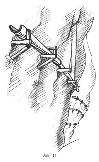
Zur Leitung grösserer Wassermengen eine Art Kanäle aus Brettern, deren Fugen und Ritzen mit Rasenstücken und Tannenzweigen ab-
