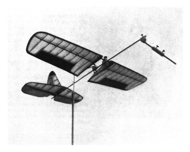
Fig. 3 Experimentierflugmodell auf einem Stativ für Beschreibungen und Erklärungen des Modells in Ruhe. Die verschiedenen Gleichgewichtslagen des Flugmodells in der Ruhe können auf diese Weise vorgeführt werden
