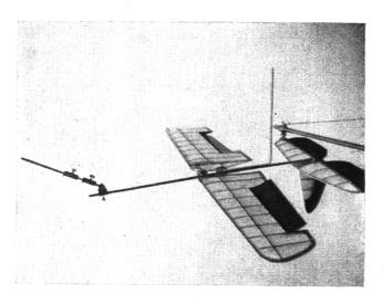
Fig. 24 Das Modell hat sich mit Hilfe der Querruder in die Rückenlage gedreht und bebewegt sich nun in die Ausgangslage zurück, um die Rotation von neuem zu beginnen
