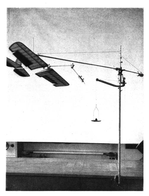
Fig. 25 Experimentier-Flugmodell am Umlaufgerät, Am langen Arm des Umlaufgeräts bewegt sich das Flugmodell. Die Energie des fallenden Gewichts liefert die notwendige Bewegungsenergie. Der Arm des Umlaufgeräts wird durch den entstehenden Auftrieb in die Höhe genommen
