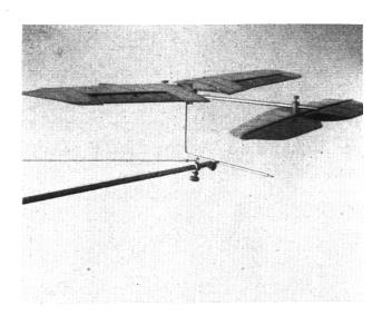
Fig. 17 Flugmodell als Hochdecker zusammengestellt. Damit der Schwerpunkt nicht zu hoch kommt, ist das Höhenleitwerk unter dem Rumpfstab angebracht
