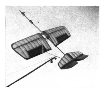
Fig. 14 Flugmodell mit Höhenleitwerk, dessen Ruder nach oben ausgeschlagen ist. (Ziehen.) Die Rumpfachse hebt sich vorne (Steigflug)
