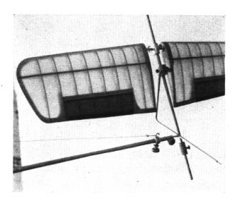
Fig. 11 In der Bewegung bleibt die Tragfläche nicht mehr in der horizontalen Lage. Sie ist instabil geworden
