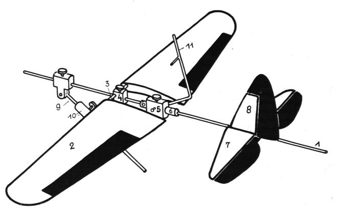
Fig. 2a Zusammengesetztes Experimentierflugmodell (Hochdecker HD)
