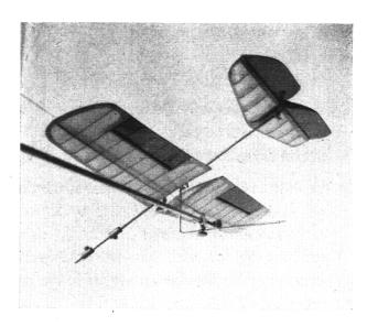
Fig. 15 Flugmodell mit Höhenleitwerk, dessen Ruder nach unten ausgeschlagen ist. (Drücken.) Die Rumpfachse senkt sich vorne
