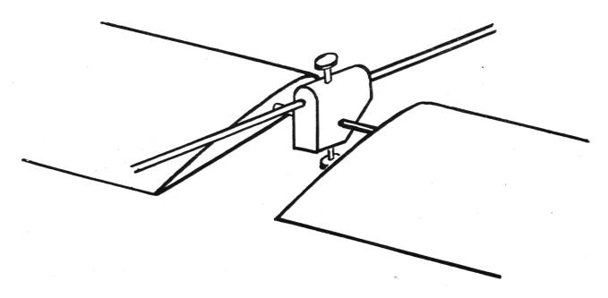
Fig. 2b Zusammenbau als Tiefdecker Das Verbindungsstück der Tragflächen ist unter dem Rumpfstab geführt
