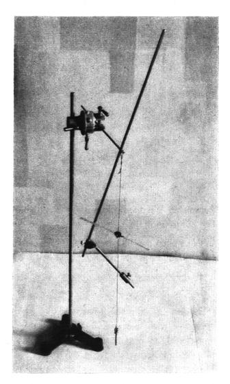
Fig. 9 Bestimmung des Schwerpunktes von zwei unter einem Winkel zusammengefügten Stäben
