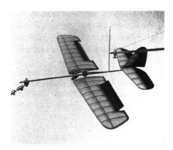
Fig. 23 Der Schwerpunkt ist verhältnismässig hoch genommen, sodass das Modell im leicht stabilen Flug fliegt. Anstellwinkel 0°. Es beginnt nun jetzt die Drehung um die Längsachse
