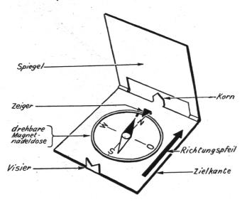
Abb. 2. Schematische Darstellung des Spezial-Kompasses.
