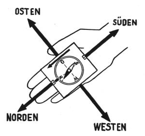
Abb. 3. Feststellen der Himmelsrichtungen.
