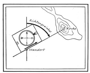
Abb. 8. Messen des Richtungswinkels mit Hilfe des Kompasses.
