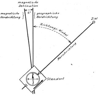
Abb. 6. Der zu messende Richtungswinkel wird durch die geographische Nordrichtung und die Richtung zum Ziel eingeschlossen.
