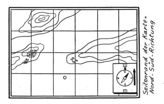
Ist das geschehen, so dreht man die Karte mit der daraufliegenden Bussole, bis die dunkle Magnet-Nadelspitze gegen die Deklinationsmarke zeigt (Abb. 5). Die Himmelsrichtungen auf der Karte zeigen nun genau nach Norden, Süden etc. in der Landschaft.
