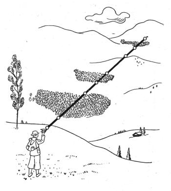
Abb. 13. Etappenweises Vorgehen durch Anvisieren von Zwischenpunkten, die in der Zielrichtung liegen.
