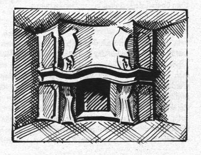
Nach aussen gebauter Ofen mit Tragstützen
