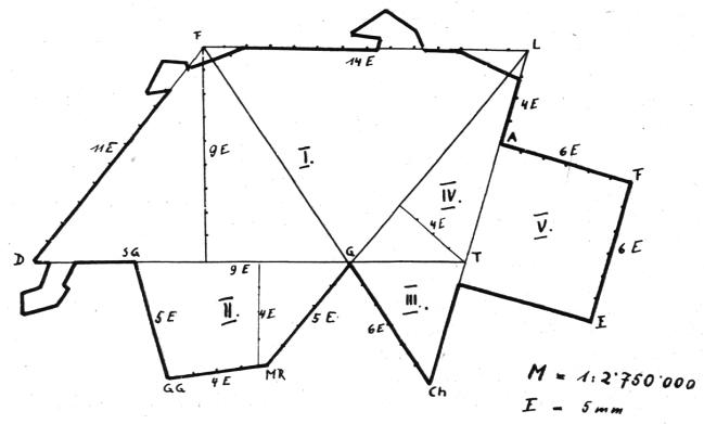
Nachher wird in einer Entfernung von 9 E eine Parallele zur Linie Feldbach-Lindau gezogen. Von Feldbach 11 E bis auf die untere Parallele abgemessen, legen den Punkt La Dôle, 11 E von Lindau aus den Griespass fest.
